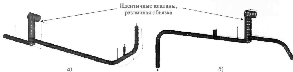
Рис. 2. Пример расчётных моделей идентичных, но по-разному обвязанных клапанов:
