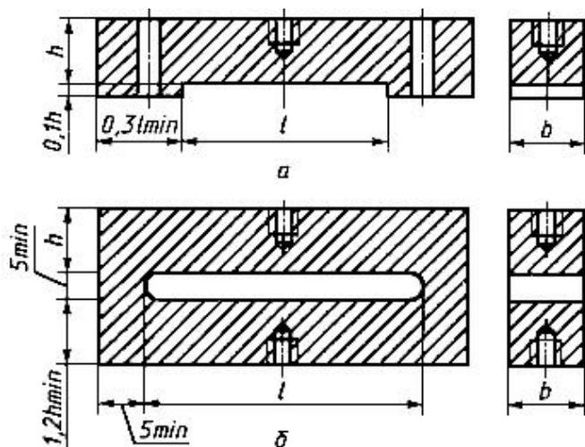
а - точки крепления балки расположены по бокам; б - точка крепления балки расположена в центре
