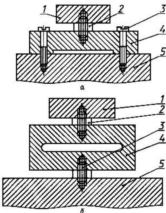
а - крепление балки к столу стенда в двух точках; б - крепление балки к столу стенда в одной точке
