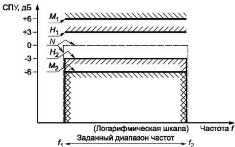
$M_1$  - верхняя граница допуска, средняя воспроизводимость;  $M_2$  - нижняя граница допуска, средняя воспроизводимость;  $H_1$  - верхняя граница допуска, высокая воспроизводимость;  $H_2$  - нижняя граница допуска, высокая воспроизводимость;  $N$  - установленная СПУ (номинальный спектр)
