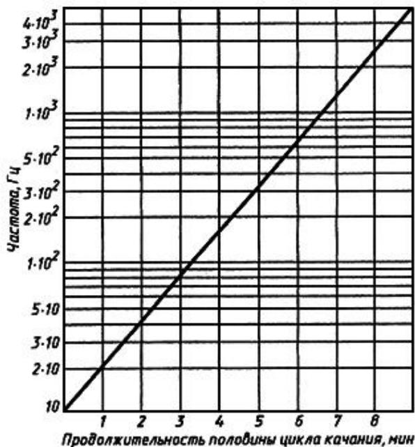
Рисунок 1 - Зависимость продолжительности половины цикла качания от частоты
